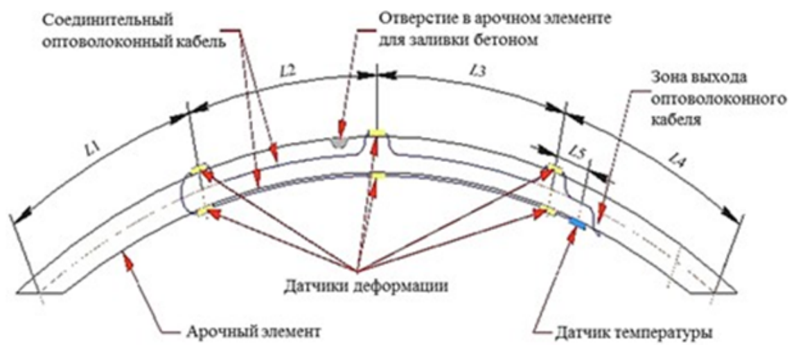
Рис. 3. Схема расположения датчиков на арочном элементе
