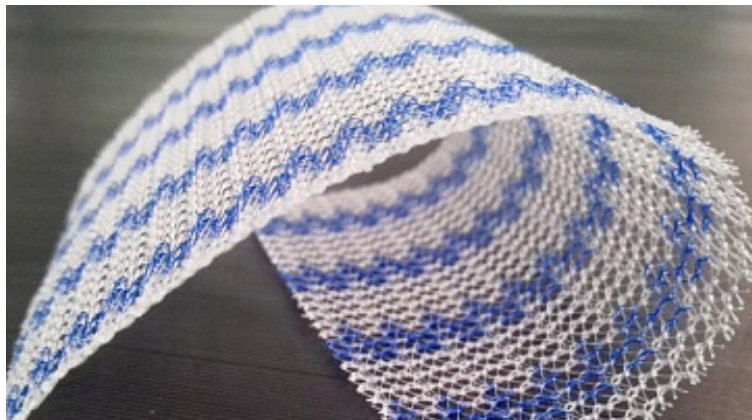
Рис. 1. Создаваемое покрытие не меняет ни эстетических, ни физических свойств самого материала. Конечный продукт внешне выглядит абсолютно так же, как обычная хирургическая сетка, т.к. толщина покрытия составляет всего 10-90 нм.
