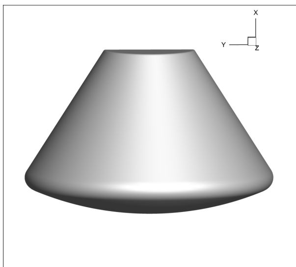
Рис. 1. Геометрия космического корабля Орион
