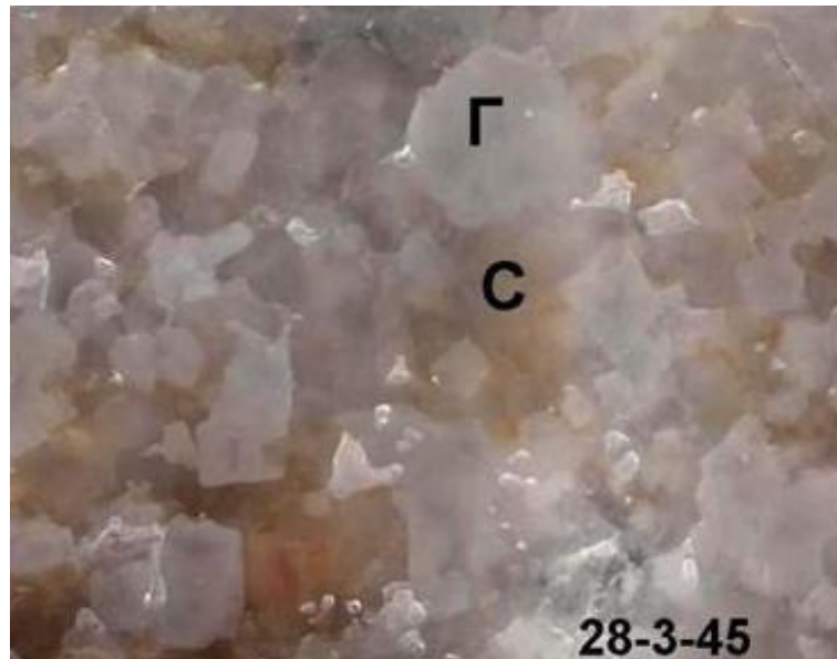
Рис. 1. Сильвинит крупнокристаллический молочно-белый массивной текстуры и с гипидиоморфной структурой. Скв. 28, обр. 3-45. Аншлиф.
