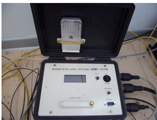
Рис. 3: Полевая станция для ГМТЗ LEM1417
