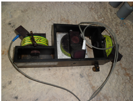
Рис. 4: Оптико-механические датчики магнитного поля для ЦМВС "Кварц-4"
