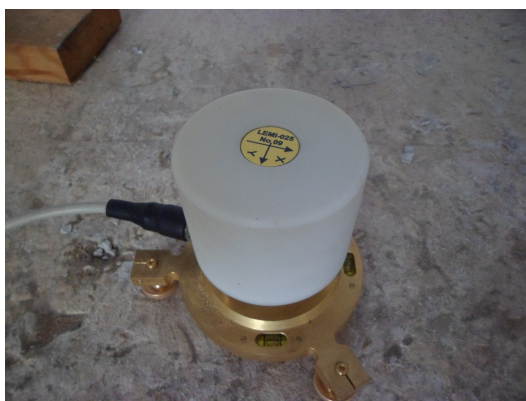
Рис. 2: Феррозондовый датчик магнитного поля для станции LEM1025
